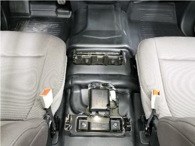
Remove factory center seat or mini console
